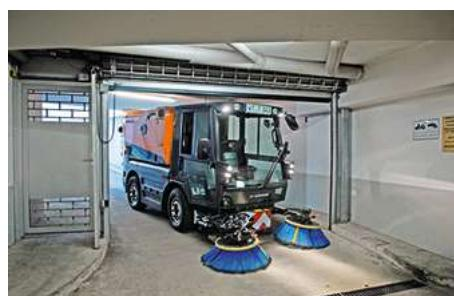
Шасси с гидропневматической подвеской, гидростатическим приводом и большими 15-дюймовыми колесами обеспечивает высочайший уровень комфорта при вождении для данного класса машин. Высокая грузоподъемность и большое пятно контакта колес обеспечивают повышенную безопасность и низкое давление на грунт независимо от дорожных и погодных условий. В качестве опции допустимая полная масса может быть увеличена до 5 000 кг.
