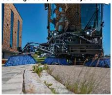
Mit dem optionalen dritten Besen kann die Arbeitsbreite auf 3 550 mm vergrössert werden. Dies ermöglicht eine grössere Flächenleistung und das Kehren auf zwei Ebenen.
