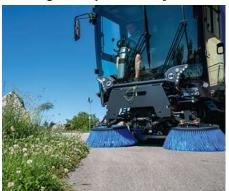
Ein flexibles Kehrsystem garantiert in jeder Situation ein sauberes Ergebnis. Das gezogene, vor der Vorderachse montierte Tellerbesensystem hat eine Kehrbreite von 2 200 mm.
