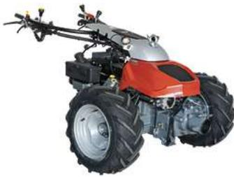
Der CC 150 wird von einem Zweizylinder-Benzinmotor mit **18 PS** angetrieben. Die kompakte Bauweise ermöglicht Arbeiten bei engen Verhältnissen aber auch den Anbau von grösseren Anbaugeräten, ohne Abstriche beim Leistungsbedarf machen zu müssen.
