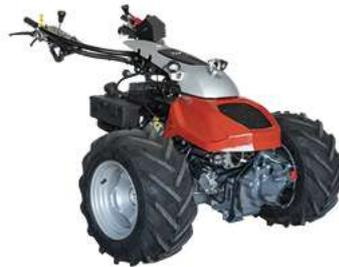
Der CC 160 ist mit einem elektronisch eingespritzten Zweizylinder-Benzinmotor mit **23 PS** ausgestattet. Die Fahrgeschwindigkeit lässt sich mit der neuen 10-Stufen-Tiptronic ergonomisch den Bedürfnissen anpassen.
