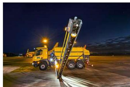
Распределительные рейки надежно закреплены на прочной раме в форме параллелограмма. Внешние секции распределительных реек изготовлены из алюминия и оборудованы системой защиты от столкновения с препятствиями.
